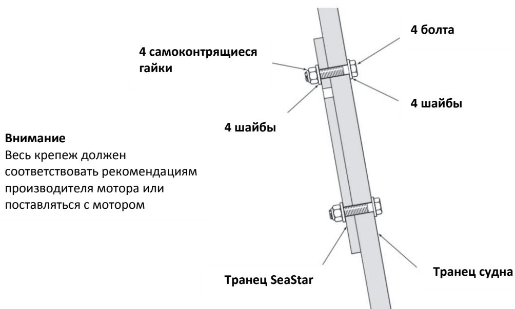
Рис. 7 Соединение транца SeaStar с транцем судна
