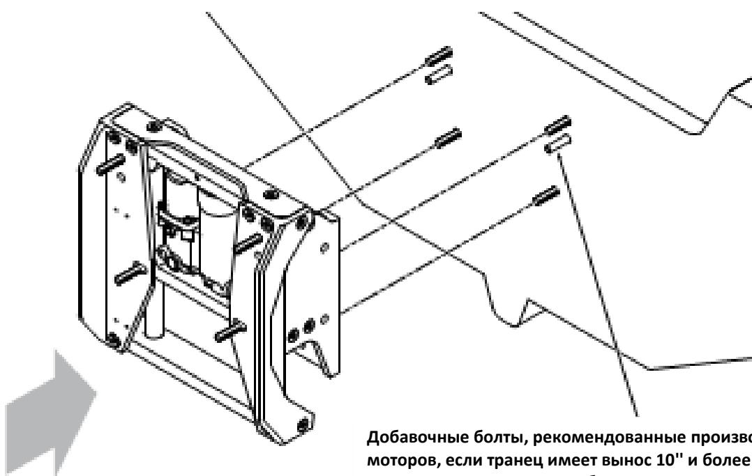
Добавочные болты, рекомендованные производителем моторов, если транец имеет вынос 10" и более или мотор имеет мощность 250 л.с. и более
