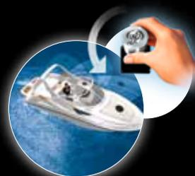
Для того, чтобы развернуть катер на 360 градусов, просто поверните вокруг оси джойстик Axius. Отличная возможность для изменения направления движения катера в ограниченном пространстве.
