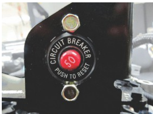
Автоматический выключатель электропроводки двигателя и блока приборов
