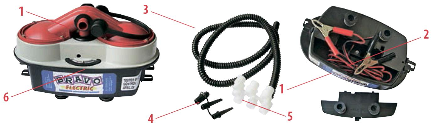
Насос состоит из корпуса (1), кабеля питания с «аллигаторными» зажимами (2), воздушного шланга (3) и переходников для различных типов клапанов (4, 5). В нижней части корпуса находится ниша для хранения кабеля питания в походном положении. Крышка ниши имеет прорезь для пропускания кабеля. На корпусе находится регулятор контроля давления (6).
