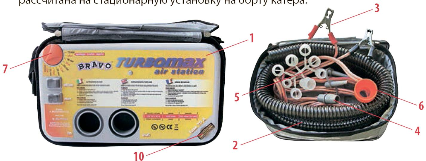
Насос состоит из корпуса (1), воздушного шланга (2), кабеля питания с зажимами «аллигаторного» типа (3), комплекта переходников для клапанов различных типов (4,5), штуцера для присоединения воздушного шланга к корпусу (6). На корпусе расположен регулятор контроля давления (7), тумблер питания насоса (8), тумблер запуска (9), гнездо предохранителя (10). Насос укомплектован сумкой для переноски с отделом для размещения шланга и кабеля.
